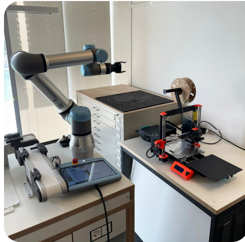
Abb. 2: UR5-Cobot von Universal Robots im Zusammenspiel mit dem mit JobOx-System ausgestatteten Prusa-3D-Drucker.
