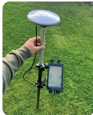
Abb. 2: Stabilisierung durch den Lotstab
