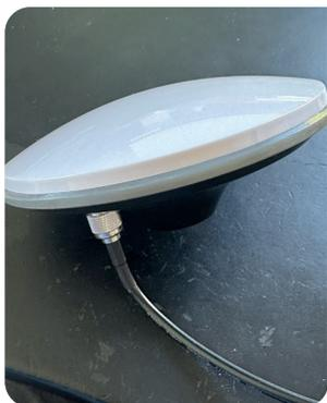
Abb. 1: Der GNSS- Empfänger sorgt für genaue Positionsdaten.
