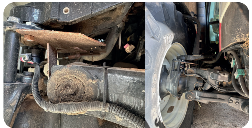
Abbildung 4: An der Vorderachse verbauter Lenkwinkelsensor
