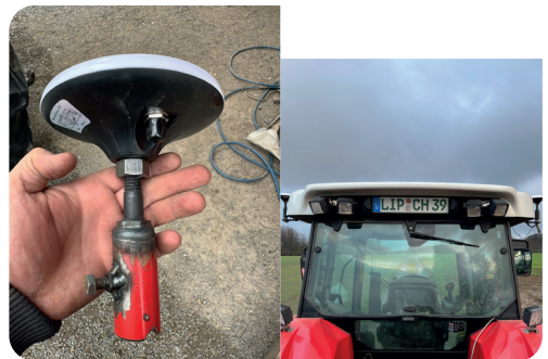
Abbildung 2: GPS-Empfänger an einer Halterung (links) und fertig montiert am Traktor (rechts)
