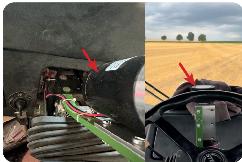
Abbildung 5: Der eingebaute Elektromotor (links) mit Reibrad (rechts)
