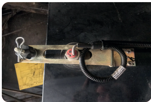
Abbildung 2: Feuchtigkeitssensor im Körnerelevator
