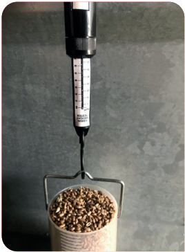
Abbildung 5: Bestimmung des Hektolitergewichts mithilfe einer Federwaage
