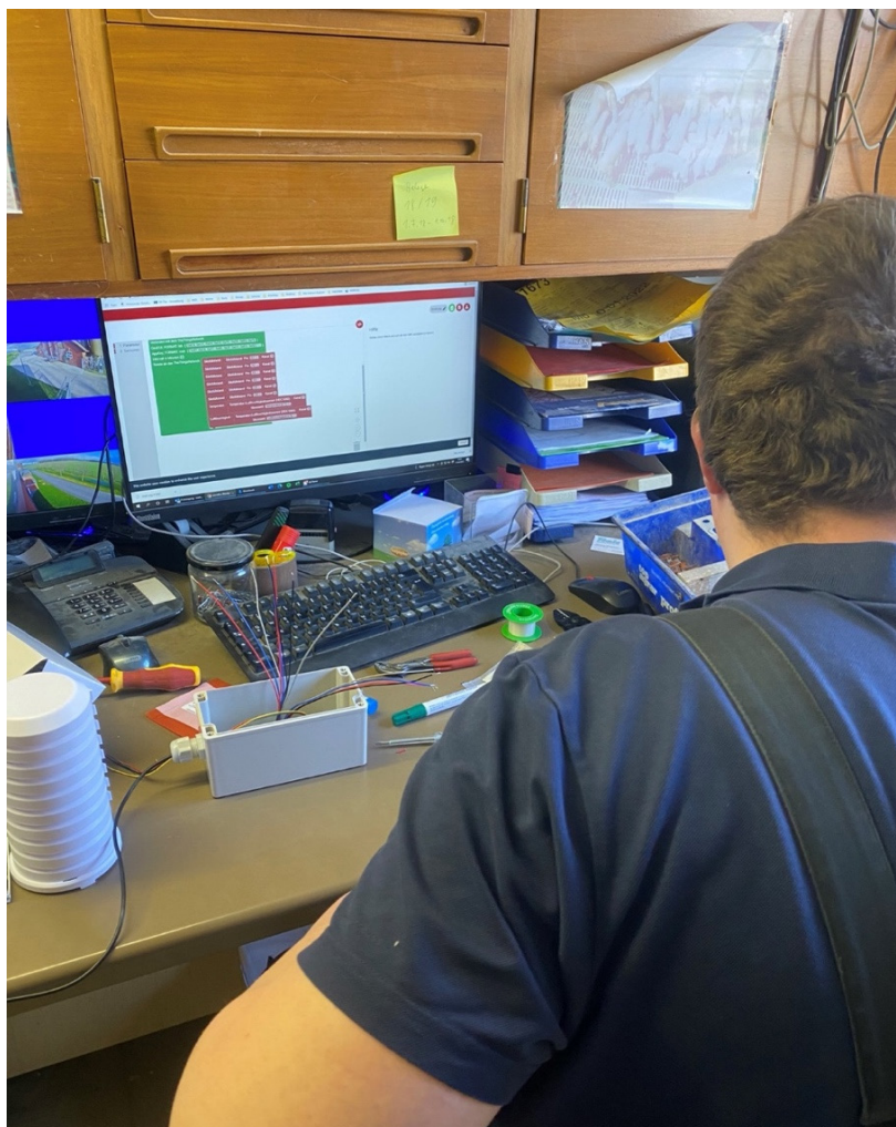
Abbildung 6: Programmierung der Silofüllstanderkennung in der Praxis (Hochschule Osnabrück 2021)
